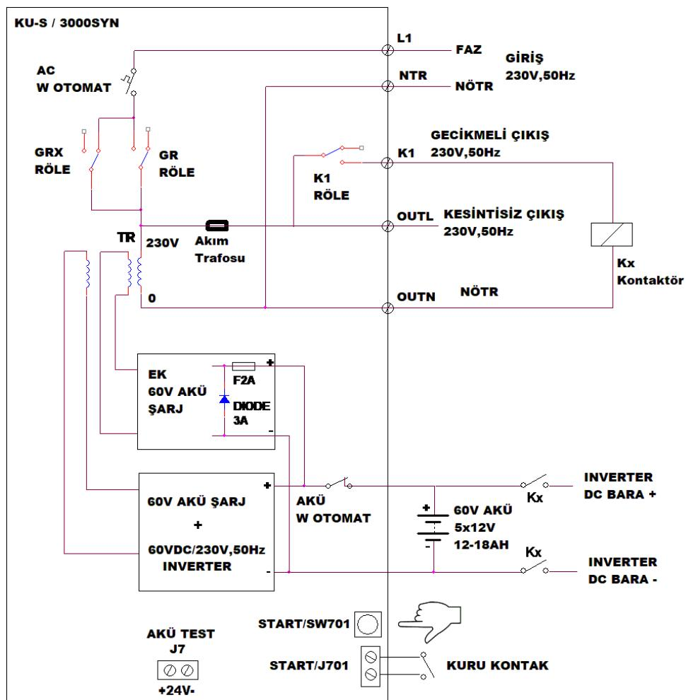
Not: Yukarıdaki şemada görüldüğü gibi gecikmeli çıkış terminalinden, istenirse, kurtarma sırasında aküleri inverterin DC barasına bağlayan kontaktör (Kx) gecikmeli olarak çekirilebilir. Gecikme süresi 20sn dir. UPS şebeke modunda ise +24- (J7) terminaline 24V DC uygulandığı zaman akü test moduna geçer. UPS i elle çalıştırılmak için (Soğuk Başlangıç) START( SV701) butonuna 2-3 sn basılı tutunuz. UPS i uzaktan çalıştırmak için J701 klemensine sadece **KURU KONTAK** bağlantısı yapılmalıdır.
